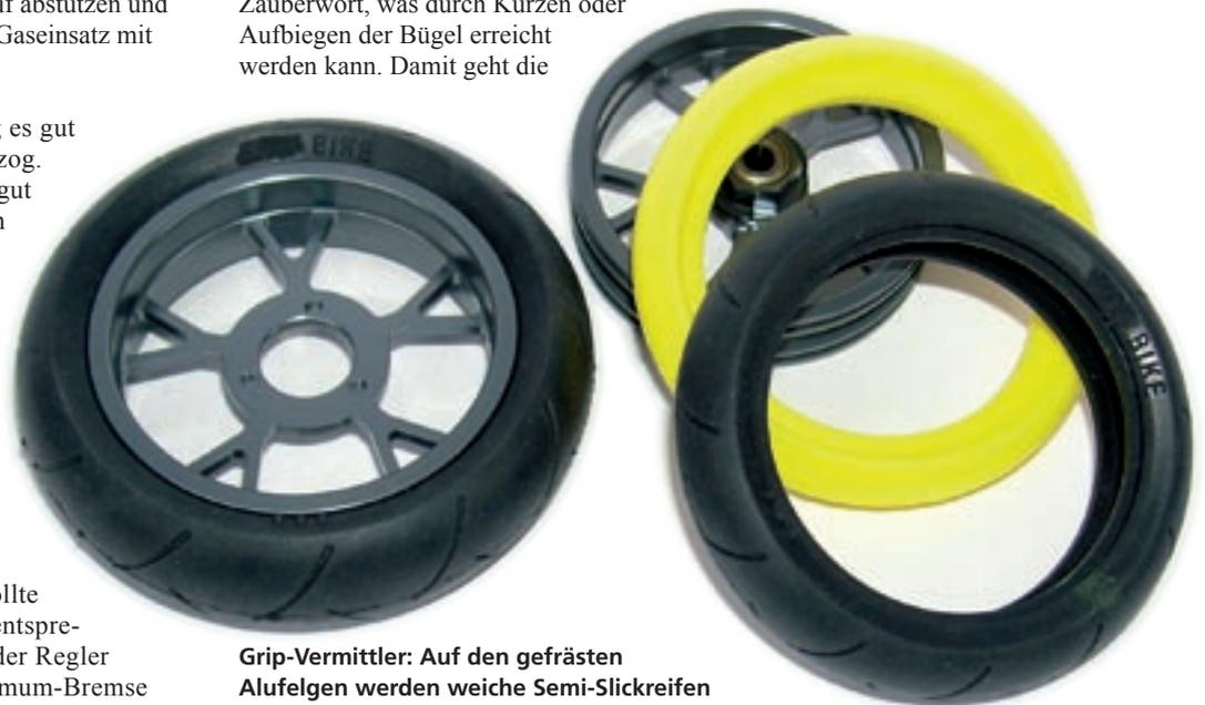
Grip-Vermittler: Auf den gefrästen Alufelgen werden weiche Semi-Slickreifen mit geschäumter Einlage aufgezogen
