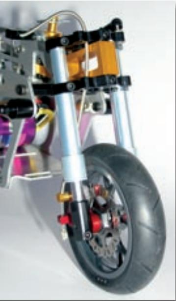
Die steife Doppelbrücken-Vorderachsgabel in USD-Bauweise und Steckachse
