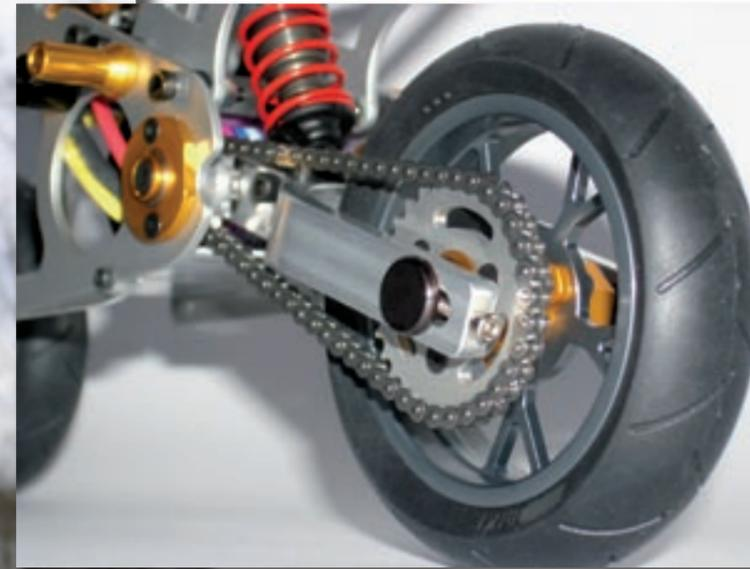
Wie im richtigen Leben gibt's eine gefräste Doppelquerlenkerschwinge an der Hinterachse mit Antrieb über Leiterkette
