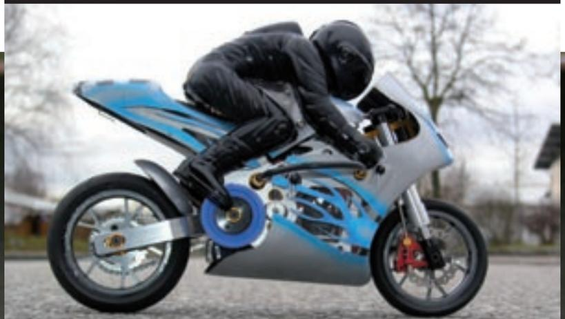
Um die Kurven-Geschwindigkeiten zu erhöhen, kann man die Sturzbügel aus Kunststoff entweder kürzen oder etwas hochbiegen
