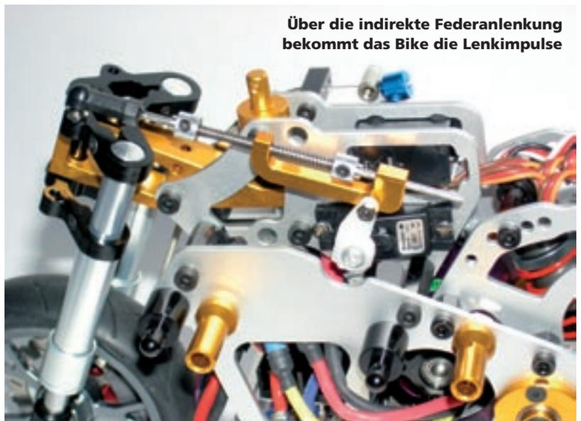
Über die indirekte Federanlenkung bekommt das Bike die Lenkimpulse
